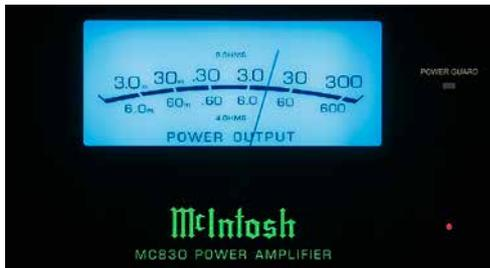
In der „Hold“-Einstellung friert das Meter der Endstufe zu Kontrollzwecken den jeweils maximal erreichten Pegel für eine kurze Zeitspanne ein.
